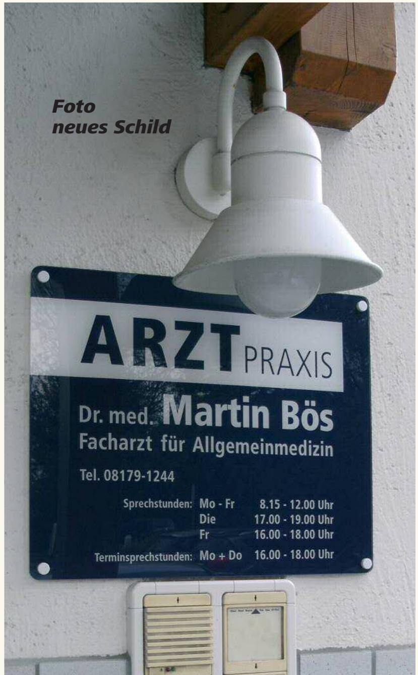
ACRYLGLAS NACH UNSEREM ENTWURF RÜCKSEITIG BEDRUCKT MIT ABSTANDHALTER UND WEISSEN ALU-ZIERKOPFSCHRAUBEN MONTIERT
